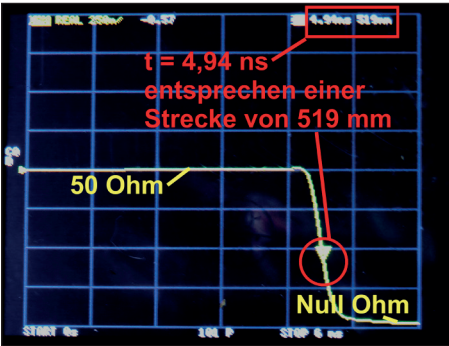
Bild 60: Die Step Response liefert dagegen ein Bild, wie man es von käuflichen TDRs her kennt: es wird zusätzlich die Impedanz an jedem Kurvenpunkt ermittelt
