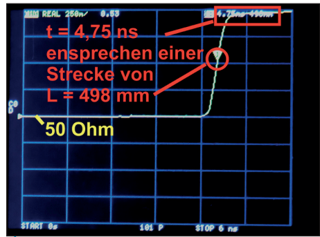
Bild 61: Am offenen Kabelende muss die Impedanz natürlich ansteigen
