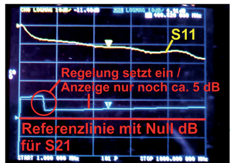
Bild 55: Beim Verstärker als Messobjekt kämpft man wieder gegen die Übersteuerung...
