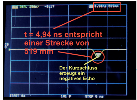
Bild 59: Vorschriftsmäßig dreht sich die Richtung des „Peaks“ bei einem SHORT um
